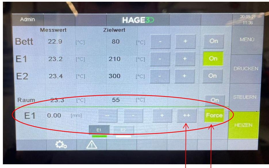
Abbildung 3: Filamentwechsel Hage 3D
